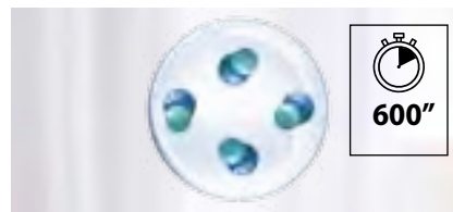
nanoe™ X-Partikel: von Wassertröpfchen umschlossene Hydroxylradikale
